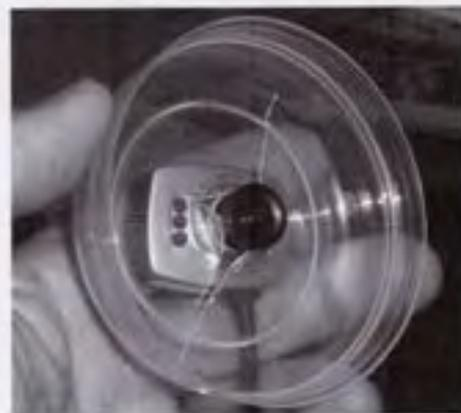
Figura 2. Cámara fijada a una tapa plástica transparente.
